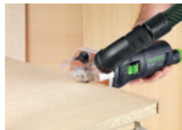
Do frezowania wyrównującego doklejek z tworzywa sztucznego lub drewna litego.
